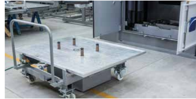
带内嵌式模具升降的模具架台车 (仅适用于某些尺寸)
