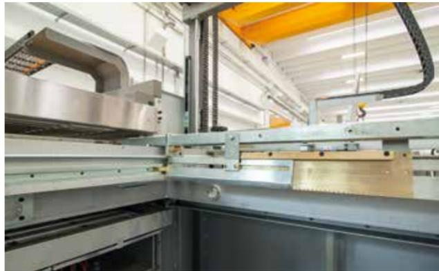
Carro portamoldes con elevación de moldes integrada
