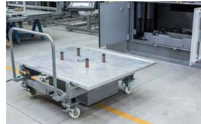
Тележка для замены пресс-форм с встроенным устройством подъема пресс-форм
