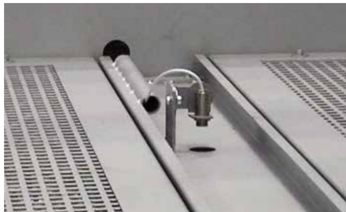
Оптический пирометр для контроля нагрева и охлаждения
