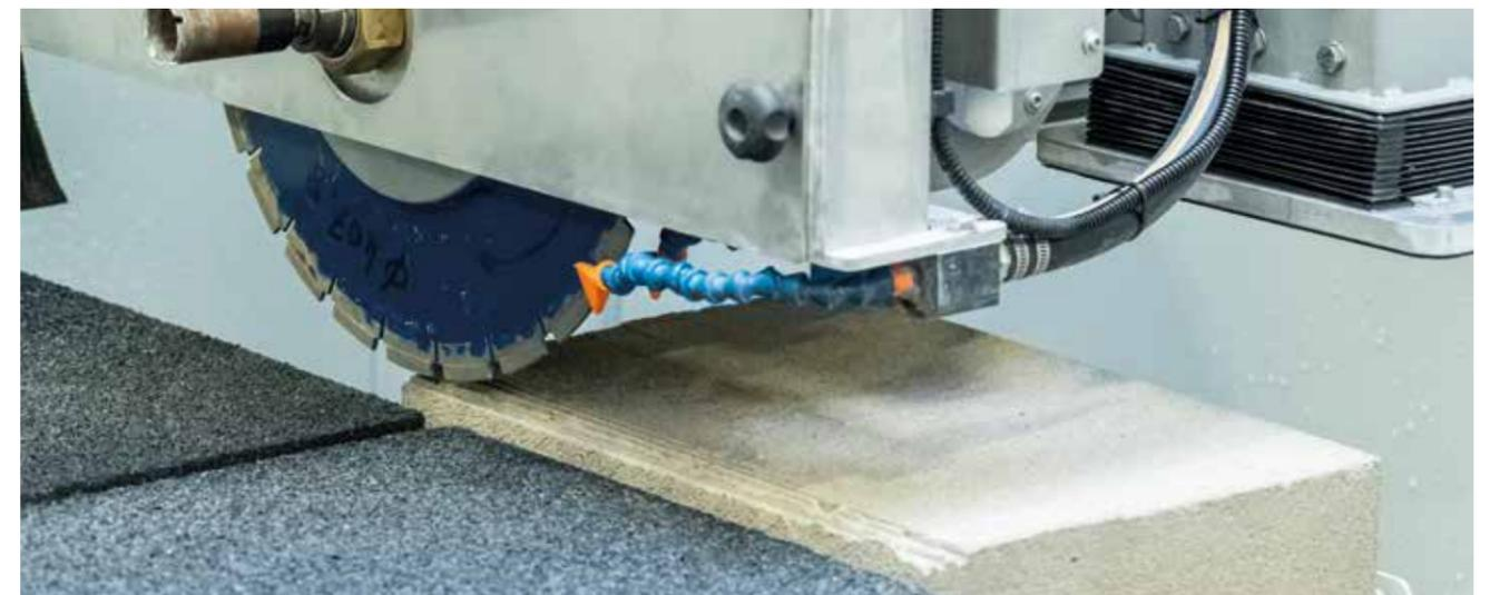
ESTAÇÃO DE REATIVAMENTO AUTOMÁTICO do disco, ativável mediante específica função presente no painel operador
