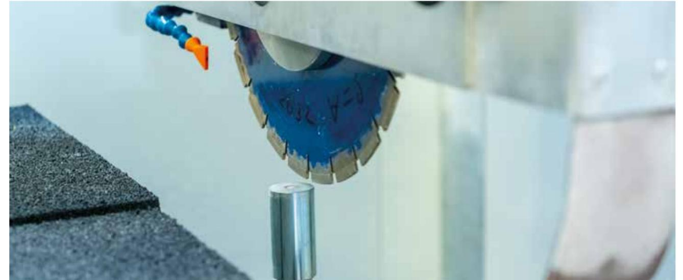
PRECONFIGURAÇÃO DO DISCO para medir o diâmetro do disco e o comprimento das cortadoras/brocas
