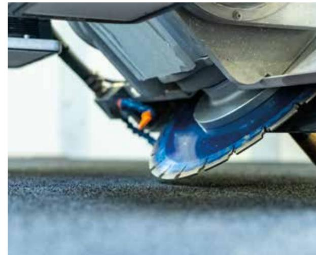
ELETTRMANDRIL gerido por inversor, que permite a regulação do n. de rotações de 0 a 5.000 rpm. Permite a utilização de utensílios diamantados tais como: cortadoras de topo ou brocas. A troca de utensílio é manual
