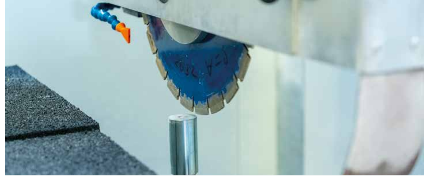
刀盘预先设置可测量刀盘直径和指形钻头或岩心钻的长度
