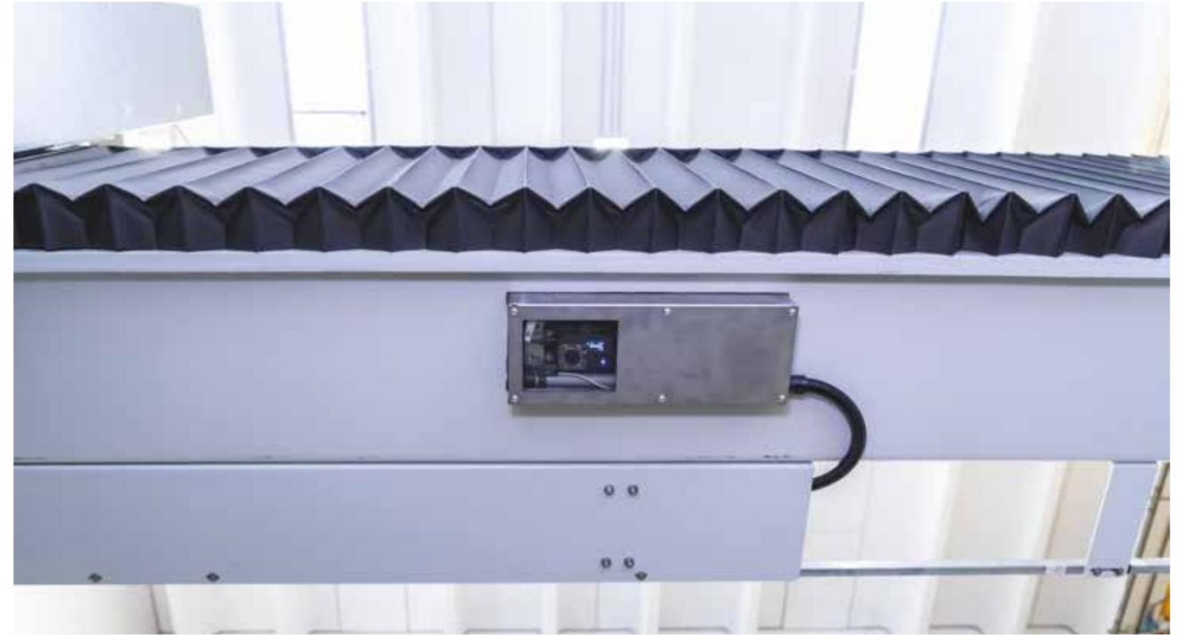
摄像头：用于获取工作台图像的系统，它可以加快石材工件的定位并测出板材上可能存在的缺陷。
