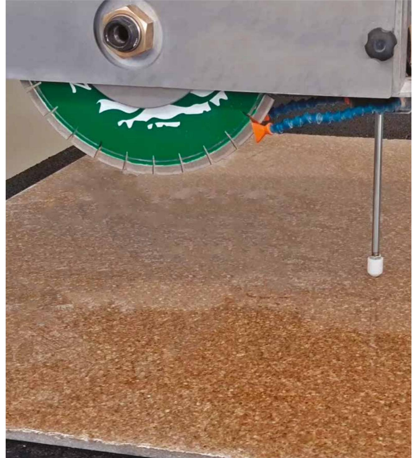
板厚测厚仪 用于自动检测石材或陶瓷块工件的厚度，对于完美执行45° 切割至关重要。
