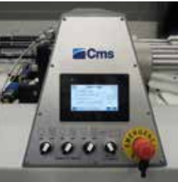
Elektronische Kontrolle des Schneidedrucks mittels Software
