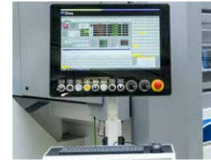
Hardware und Software, aus einer Hand, entwickelt zur einfachen Steuerung aller Funktionen der Anlage, inklusive Schnittpaltenkompensation (JD5) für 5-Achsen-Maschinen.
