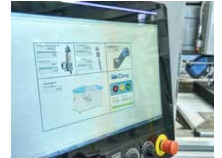
Hardware und Software, aus einer Hand, entwickelt zur einfachen Steuerung aller Funktionen der Anlage, inklusive Schnittpaltenkompensation (JD5) für 5-Achsen-Maschinen.
