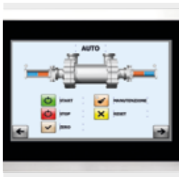
TOUCH-STEUERUNG 17'' für Ferndiagnose, eistungsprüfung, Zyklusanzahl und elektronische Drucksteuerung
