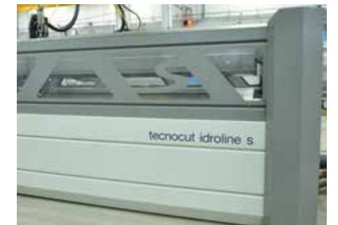
Rahmen und Türen: Monoblockgestell mit Edelstahltank seitlich geöffnet mit automatischen Sicherheitsschranken. Kompletter geschützter Arbeitsbereich durch automatische Hubtüren.
