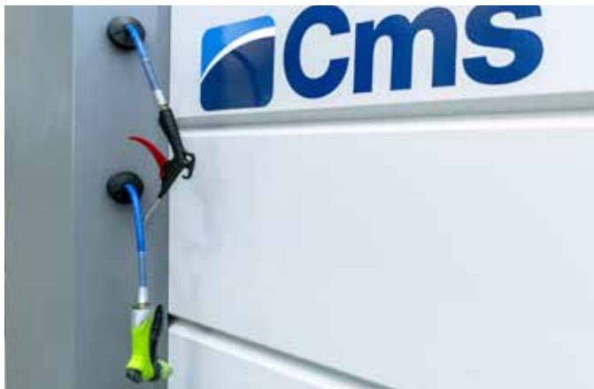
AUTOMATISCHE SCHLAUCHAUFROLLER: Luft- und Wasserpistole zur Reinigung und Trocknung der Bauteile.
