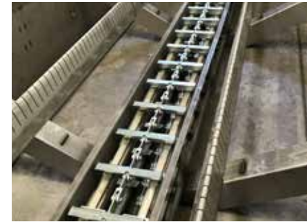
Kettenförderer: zur automatischen Austragung des Abrasivschleifmittels aus dem Maschinenbecken.
