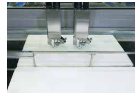
Verfügbar mit einem oder mehreren Schneidköpfen sowie kompletten oder geteilten Arbeitsbereich für pendulares Arbeiten.
