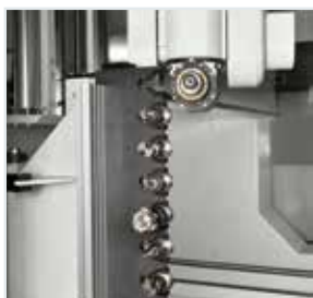
Lineares oder Teller-Werkzeugmagazin an der rechten Säule des Portals befestigt.
