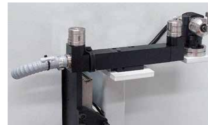
Система юстировки осей вращения с лазером для измерения длины и диаметра инструментов
