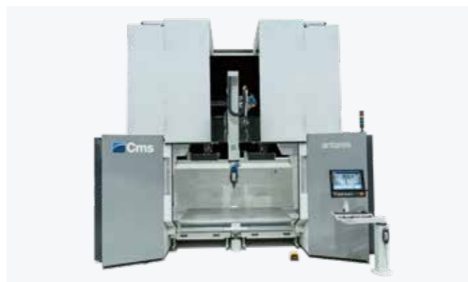
Цельная звукопоглощающая кабина для удержания пыли с внутренним освещением
