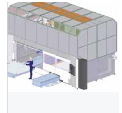
Версия с поворотным столом. Стол гарантирует легкий доступ к рабочей зоне в условиях полной безопасности.
