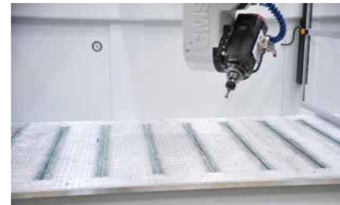
Plano de aspiração em alumínio com ranhuras em T em aço
