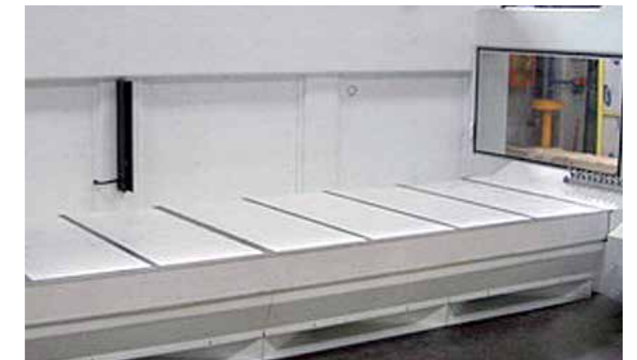
Bocas de aspiração
