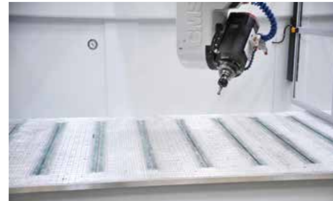
Plan d'aspiration en aluminium avec rainures en T en acier
