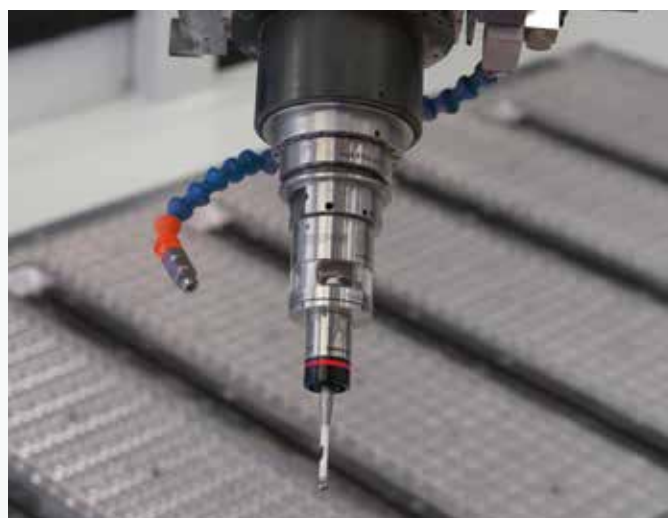
Измерительный щуп, установленный на держателе инструмента с передачей сигнала по радиосвязи.
