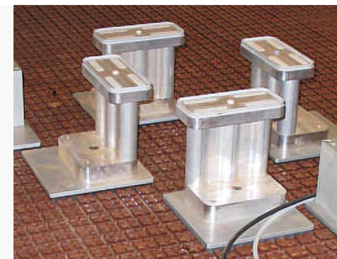
Присоски и контрольные стопоры для максимальной гибкости зажима детали
