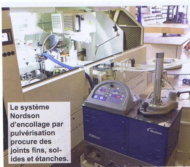
Le système Nordson d'encollage par pulvérisation procure des joints fins, solides et étanches.
