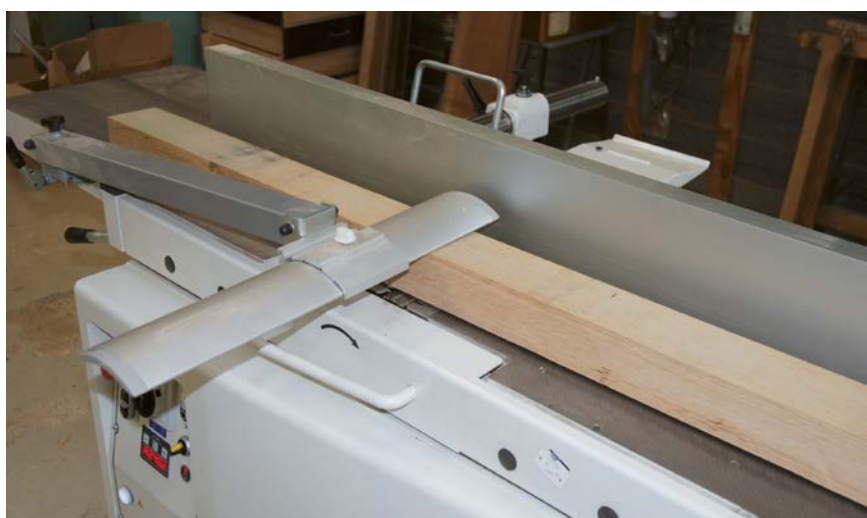
Les tables sont en robuste fonte finement usinée et le guide de dégauchissage est d'une exceptionnelle rigidité.
