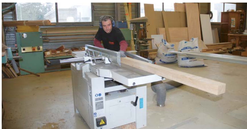
La table longue est particulièrement robuste et ne souffre pas lors du dégauchissage de pièces longues et/ou lourdes.
