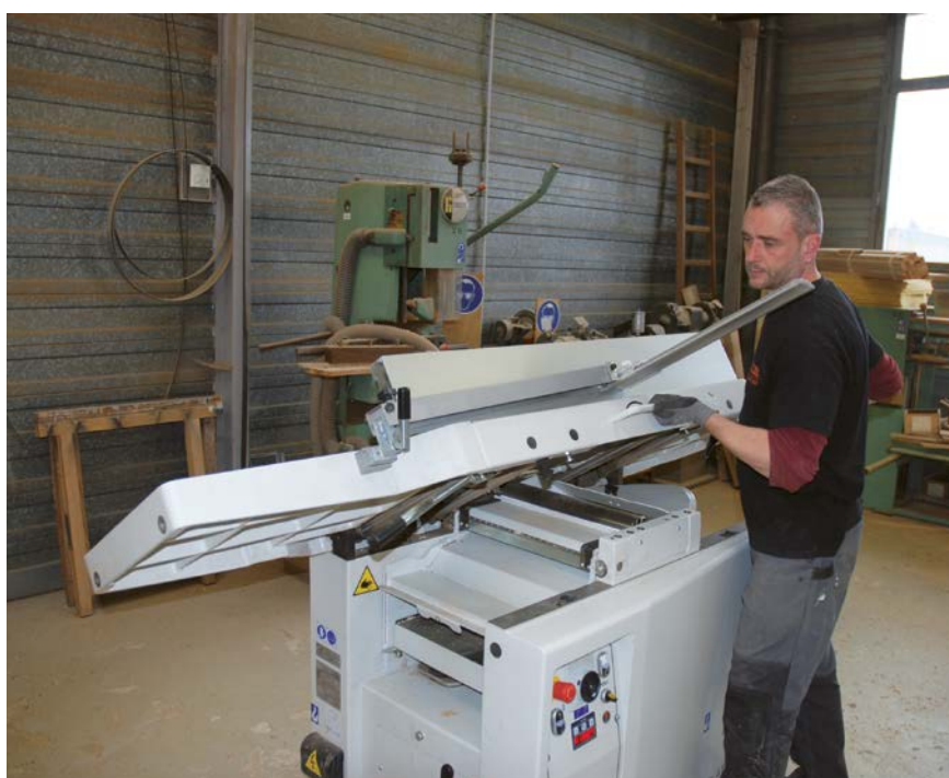
Contrairement à ce que l'on pourrait penser de prime abord, la table se relève avec une grande facilité en une seule fois.
