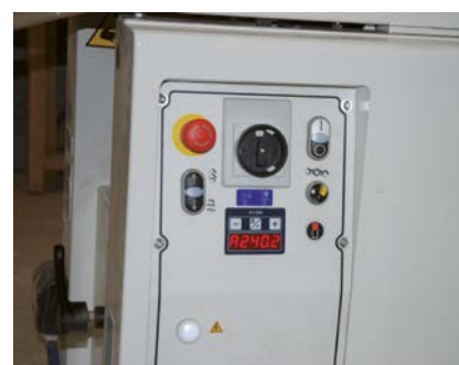
La montée/baisse de la table de rabotage est disponible en version motorisée (sur option) avec indicateur digital de la hauteur de cote, précis au 1/10 de mm.
