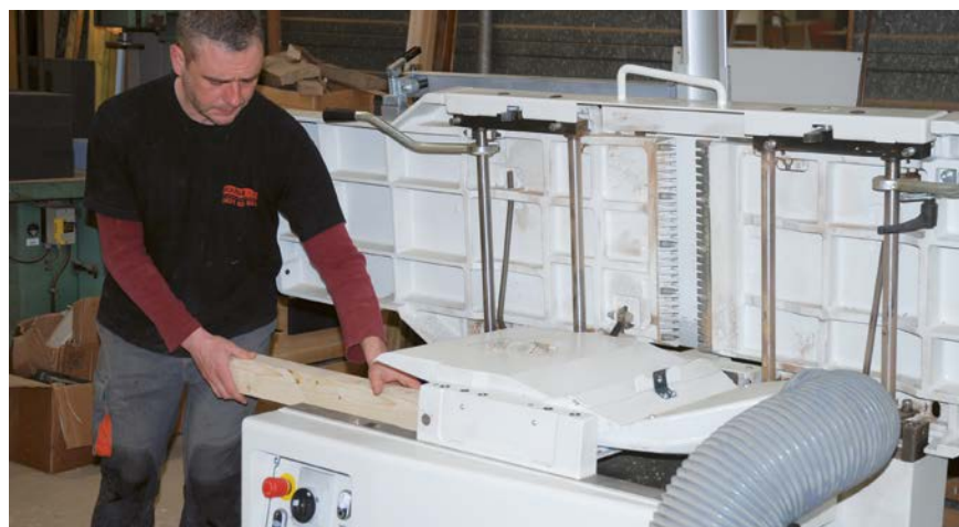
Le passage des bois n'appelle pas de commentaires, pas plus que l'efficacité de travail, l'usinage est aussi efficace que finement exécuté. Il faut dire que l'arbre à quatre fers qui équipe la FS 41 Elite S y est sûrement pour quelque chose.
