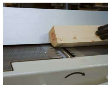
Le guide de dégauchissage est facilement inclinable de 90 à 45° ; la manœuvre est souple et pratique et le guide une fois bloqué maintient parfaitement le réglage pendant toute la durée de l'usinage.
