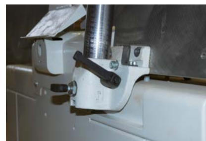
Petit bémol : il faut penser impérativement à tirer le guide à soi et à bien le verrouiller avant de relever les tables sous peine de ne pouvoir mener à bien la manœuvre ; la tige du guide venant buter contre le bâti et empêchant le blocage en position haute.
