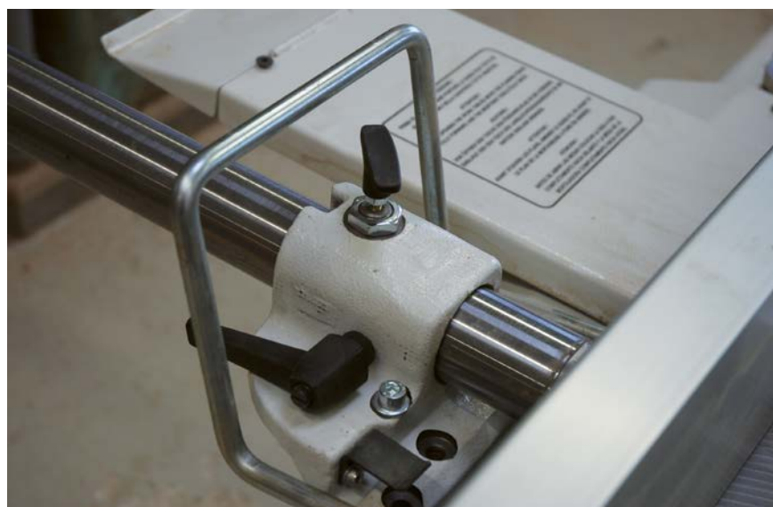
Du côté de la fixation du guide sur la machine, pas de soucis à se faire, le sabot est en fonte d'une solidité à toute épreuve.
