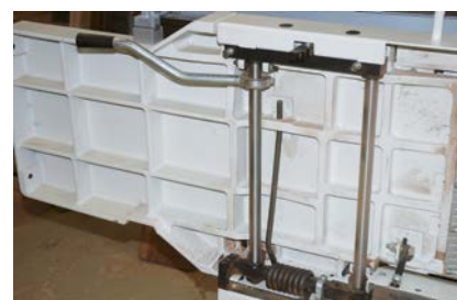
Le système de relevage est très mécanique et c'est très bien ainsi... Permettez-moi de vous faire remarquer le dimensionnement important du ressort de rappel !...
