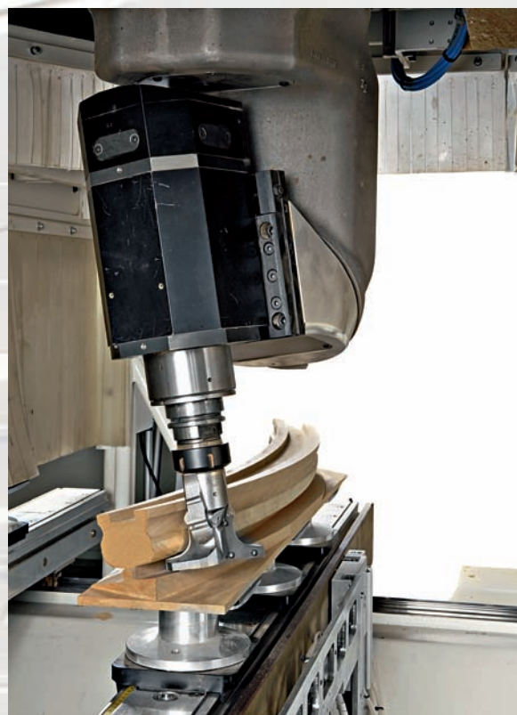
Un sistema realizzato da SCM Group utilizzato nella lavorazione di un corrimano
