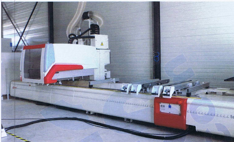
La Tech Z5-52 permet d'usiner (fraisage horizontal et vertical) et fraiser des panneaux de toutes sortes de bois, massif.
