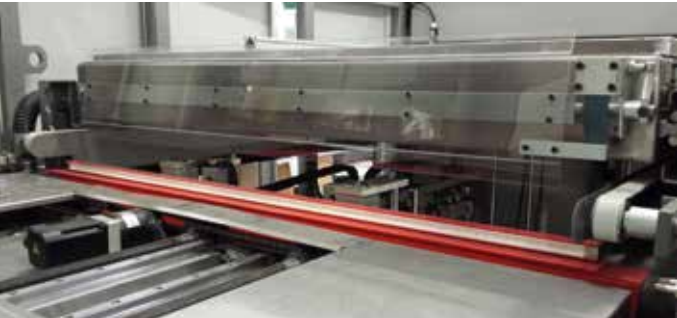
Pirometri ottici: il ciclo di riscaldamento lastra e quello di raffreddamento pezzo vengono controllati in tempo reale con pirometri a lettura ottica ad alte performance.
