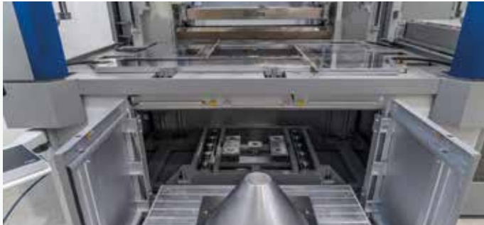
Cambio rapido stampo: piano stampo estraibile con carrello dedicato. Il carrello può essere equipaggiato con dispositivo di sollevamento stampo per il massimo in termini di velocità di cambio produzione. Semplifica le operazioni di centraggio ed installazione delle attrezzature all'esterno della macchina.
