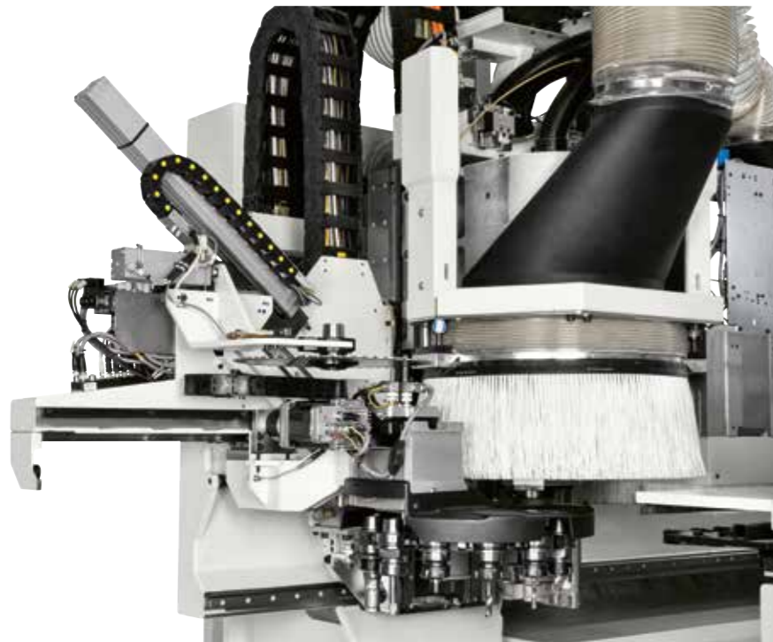
“VELOCE”机载换刀刀库 设有12或16个刀位, 位于电主轴旁边, 能够在进行上一个工序的时间内更换刀具。除其他刀具外, 还提供拾取式刀片。
