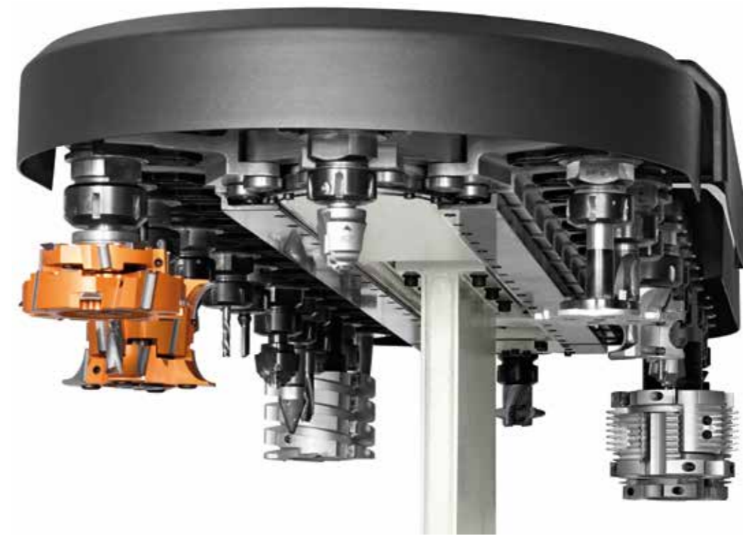
由于后方设有多达32个刀位的刀库, 操作员随时可以使用大型工具库。
