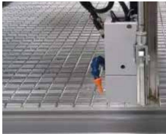
OPTISCOUT 该设备能够定位塑料和纸质材料上的基准，通过程序的旋转和平移，补偿实际零件的位置和方向。
