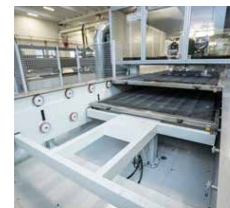
АВТОМАТИЧЕСКАЯ СМЕНА ПОДДОНОВ Отдельные зоны погрузки и разгрузки с автоматическим перемещением поддонов с помощью серводвигателя.
