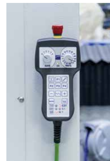
Выносной пульт для управления до 6 осями, что позволяет работать вблизи плоскости резки и устанавливать несколько исходных точек.
