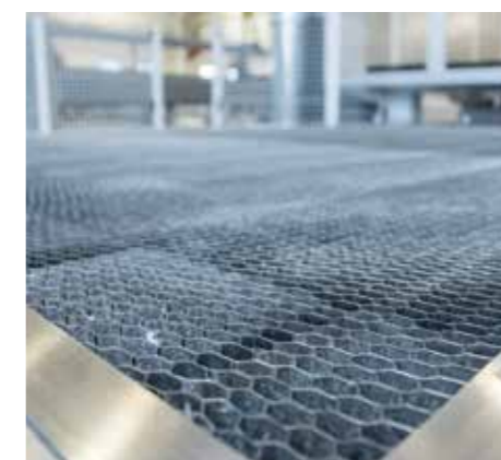
ОПОРНАЯ ПОВЕРХНОСТЬ Сотовая решетка из нержавеющей стали предназначен для резки пластиковых материалов.
