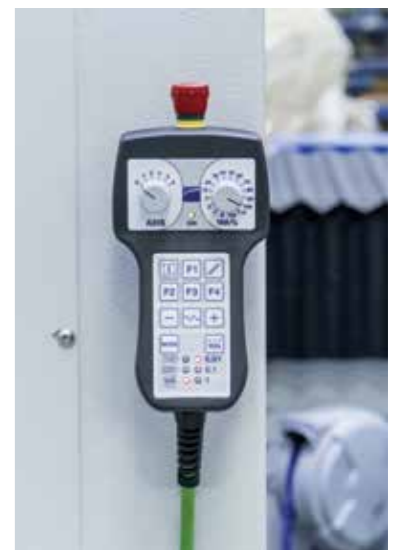
Botoeira remota para controlo de até 6 eixos que permitem operar perto do plano de corte e de configurar multi-fontes.
