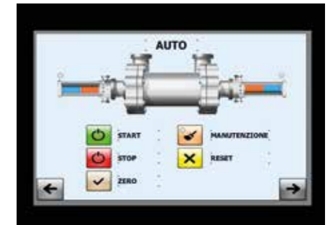
17 "TOUCH CONTROL para diagnóstico remoto, controle de potência absorvida, número de ciclos e gerenciamento eletrônico de pressão (somente em Tecnocut Greenjet Evo Stand Alone)
