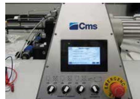
Controlo eletrónico da pressão de corte
