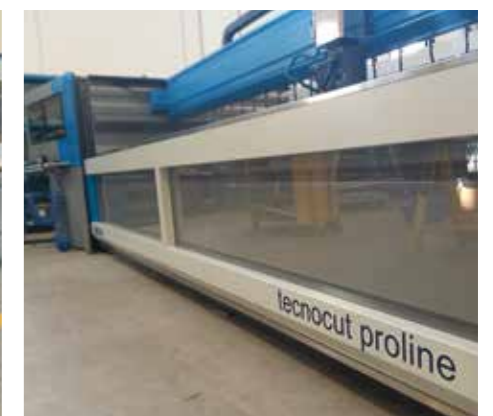
Porta frontal e traseira com movimento pneumático para melhor proteção da área de corte e contenção das reverberações de água e abrasivos.
