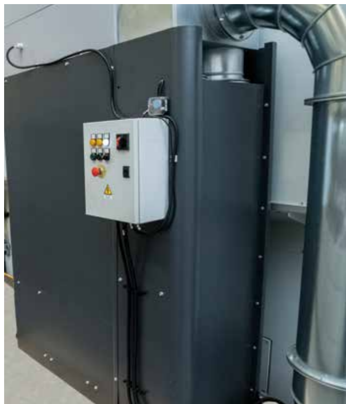
ASPIRAÇÃO DO VAPOR Sistema de aspiração para a evacuação do vapor com filtro absoluto HEPA 99,997%, posicionado na lateral da máquina.
