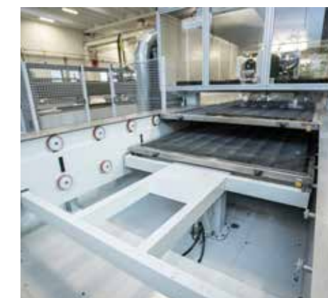
TROCA AUTOMÁTICA DE PALETES Zonas de carga e descarga separadas com movimentação automática de paletes por servomotor.
