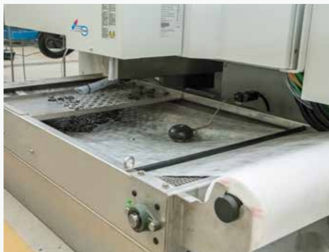
SISTEMA DE FILTRAÇÃO DE ÁGUA DE DESCARGA Um sistema automático leva os descartes na parte traseira da máquina onde um filtro de papel com um tanque de recolha limpa as águas residuais.
