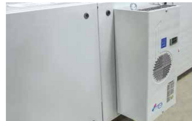
Klimaanlage für den Schaltschrank des Schneidtisches für Umgebungstemperaturen zwischen 35 °C und 40 °C.
