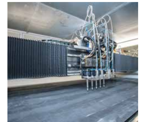
BEWEGUNG Antrieb mit Ritzel und Zahnstange mit hoher Präzision und Leistung.
