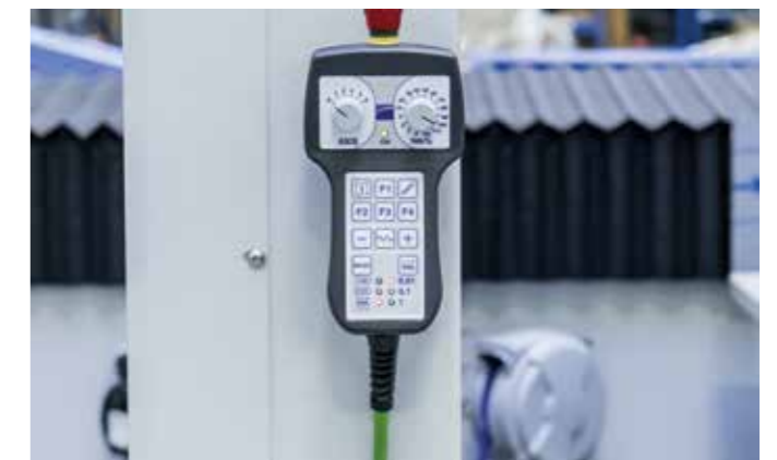
Fernbedienfeld für die Steuerung von bis zu 6 Achsen, für die Arbeit in der Nähe des Schneidtisches und die Einstellung von Mehrfach-Ursprungspunkten.
