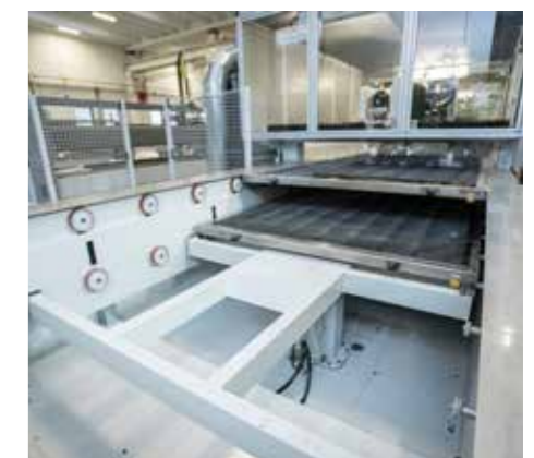
AUTOMATISCHER PALETTENWECHSEL Separate Be- und Entladebereiche mit automatischer Palettenbewegung über Servomotor.
