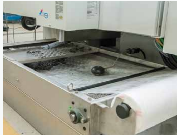
FILTERANLAGE FÜR ABWASSER Eine automatische Anlage führt den Ausschuss auf die Rückseite der Maschine. Dort reinigt ein Papierfilter mit einem Auffangbehälter das Abwasser.
