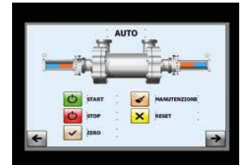
TOUCH-STEUERUNG 17" für Ferndiagnose, Leistungsprüfung, Zyklenanzahl und elektronische Drucksteuerung
