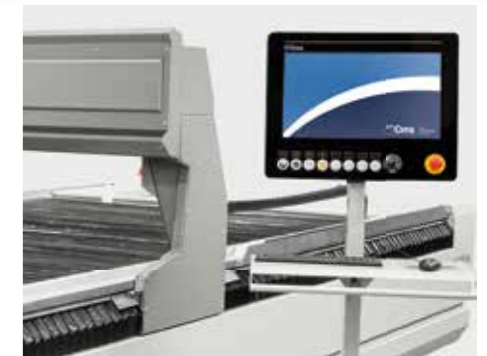
21.5英寸触屏控制台，位于活动滑架上
