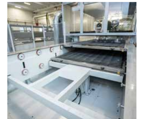
自动换托盘 装卸区分开，带有伺服电机驱动的自动搬运托盘系统。
