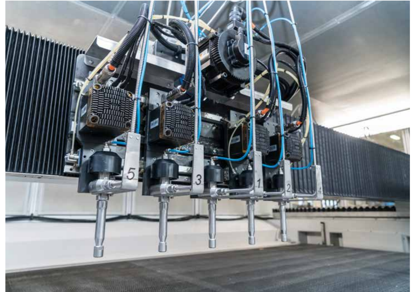
多头 由3头或5头滑架构成的纯水射流附加切割头，所有轴距都可自动调节，使切割加工过程中性能达到最高。切割头的间距采用数字控制。 选配：双滑架达到最大生产率。
