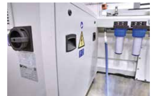
电气面板集成于槽基座，减少落地体积。
