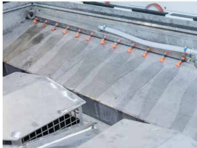
水槽自动清洁系统 水槽内部有一组喷嘴，可将加工碎屑送到外部的排放过滤器
