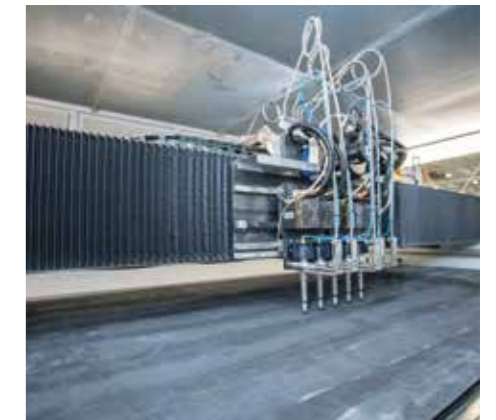
搬运 高精度、高性能齿轮齿条传动。
