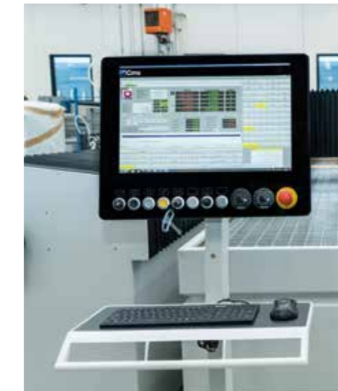
21.5英寸触屏控制台，位于活动滑架上
