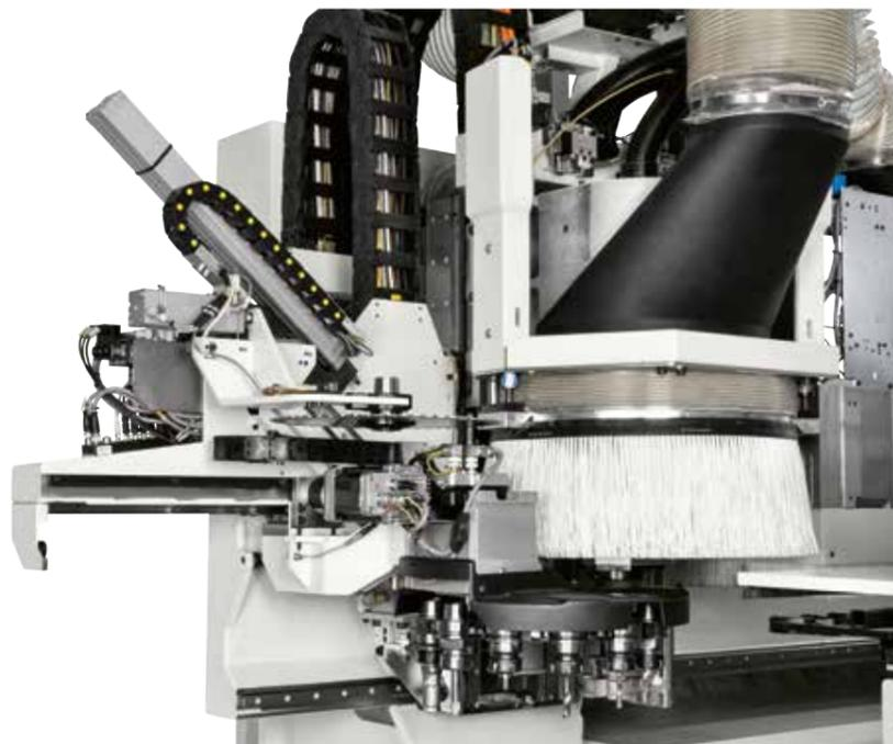
**El almacén de cambio utillaje a bordo "RÁPIDO"** con 12 o 16 posiciones, situado junto al electrohusillo, permite el cambio utillaje en tiempo enmascarado. También disponible con recogida de la cuchilla, además de las otras herramientas.
