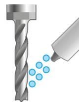
**Soplador de aire ionizado en el electrohusillo** Indicado para eliminar las cargas electrostáticas acumuladas en el material cortado, lo que facilita la aspiración de virutas en múltiples materiales plásticos.
