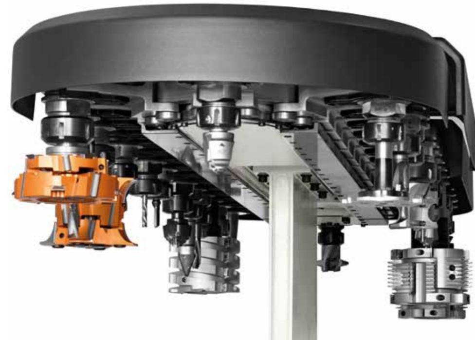
Amplio parque de utillaje siempre a disposición del operador gracias a los almacenes traseros de hasta 32 posiciones.
