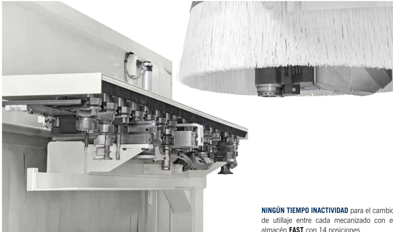
**NINGÚN TIEMPO INACTIVIDAD** para el cambio de utillaje entre cada mecanizado con el almacén **FAST** con 14 posiciones.
