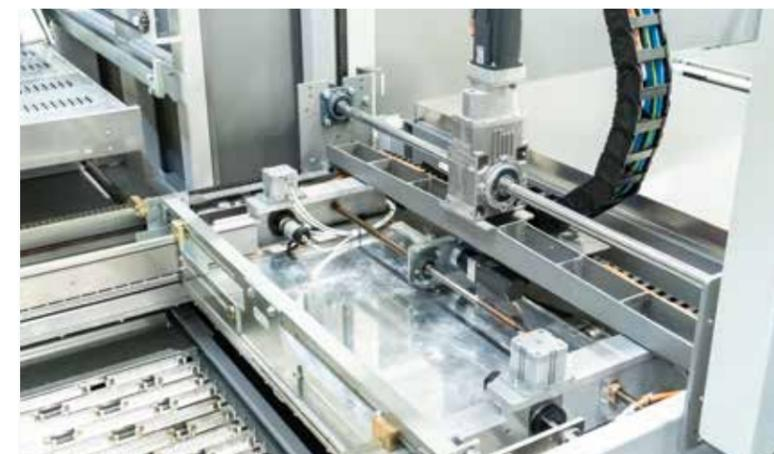
Automatischer Vorspannrahmen: vollautomatisches Verstellsystem mit teleskopierbaren Querstangen. Er deckt alle Formate ab, ohne dass manuelle Werkzeuge erforderlich sind, und garantiert so jederzeit maximalen Halt für die Platte.
