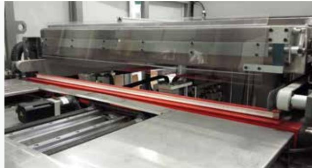
Automatische 25-mm-Reduzierplatte: Membransystem zur Anpassung der Maschinengröße an die Form, wodurch der Materialverlust minimiert wird, ohne dass spezielle Werkzeuge erforderlich sind.
