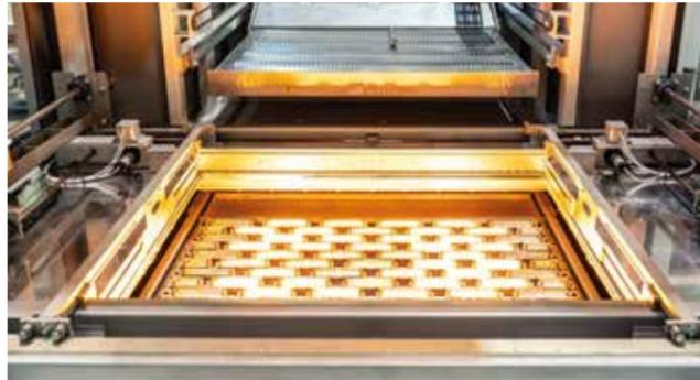
Neues Halogen-Heizsystem mit nahtloser Leistungsregelung in Echtzeit zur besseren Anpassung an die thermischen Eigenschaften des Materials. Es besteht die Möglichkeit, eine hohe oder niedrige spezifische Leistung in 2 verschiedenen Versionen von Infrarotfrequenzen zu wählen.
