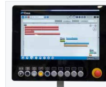
**Die neue ThermoActive CMS HMI-Software wurde speziell für den Thermoformprozess entwickelt.** Die Zeitleiste und das einzigartige Dashboard machen sowohl die Produktionsüberwachung als auch die Prozesskontrolle unmittelbar und einfach zu interpretieren.
