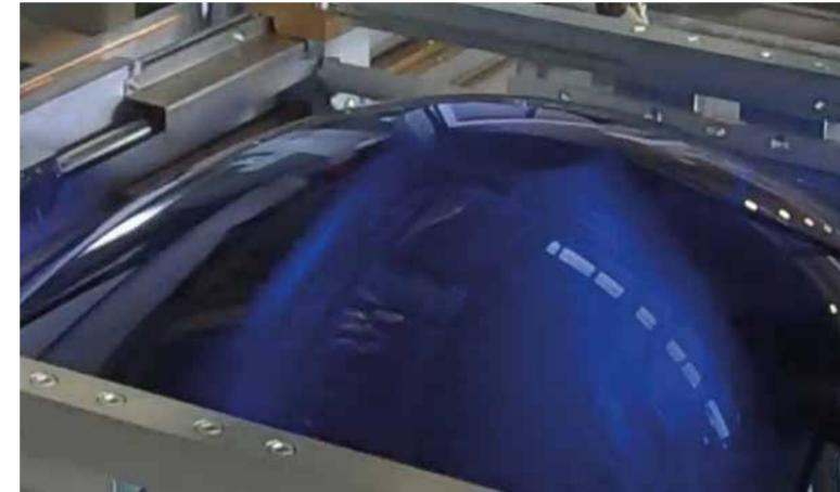
Elektronisches Plattentiefziehsystem: Die Tiefziehfunktion wird über ein elektronisch gesteuertes Gebläse realisiert. Die Kontrolle der Tiefziehhöhe wird mit einem Laser-, Infrarot- oder Ultraschallsensor durchgeführt.
