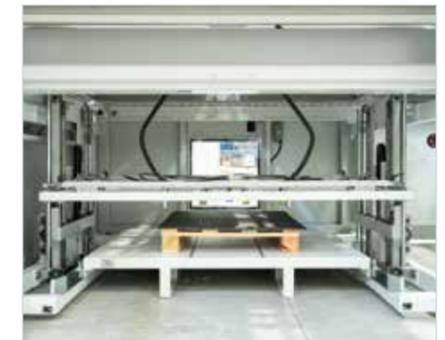
**Neues Plattenzentriersystem mit schwimmendem Rahmen** für schnelleres Laden. Dieses System bietet eine größere Toleranz bei anfänglichen Ausrichtungsfehlern.
