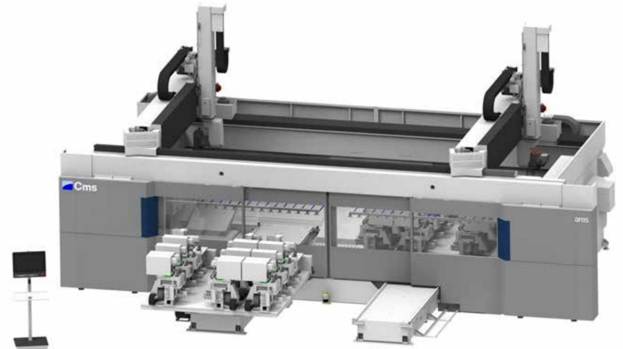
Ares con mesas de trabajo extraíbles APC (Automatic Pallet Change) con doble puente y unidad de 5 ejes con 3 mandriles
