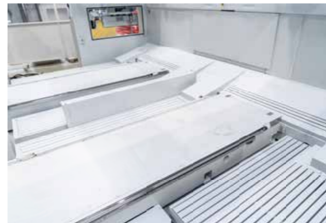
Стационарные всасывающие емкости по бокам столов
