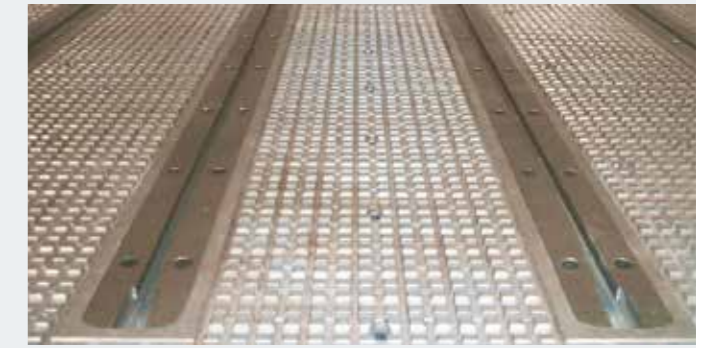
Алюминиевый всасывающий блок с Т-образными пазами
