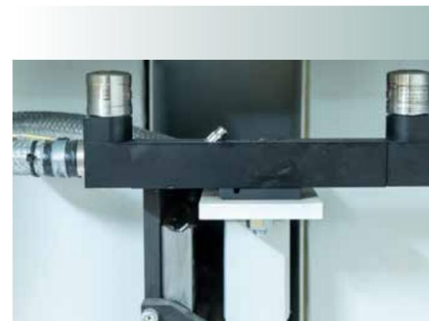
Dispositivo a laser para medição do diâmetro e comprimento da ferramenta
