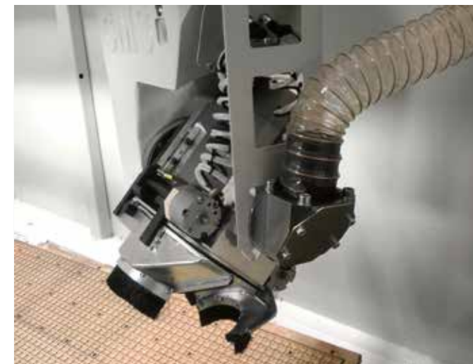
Cuffia di aspirazione a 5 assi per una aspirazione concentrata sulla zona di taglio. Apertura pneumatica per cambio utensile e svincolo.
