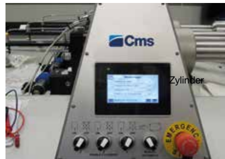
Elektronische Kontrolle des Schneidedrucks mittels Software
