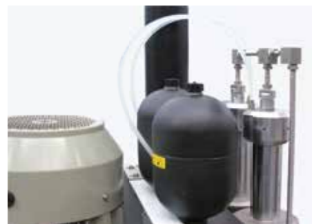
Аккумулятор азота для управления обратным контуром гидроцилиндров
