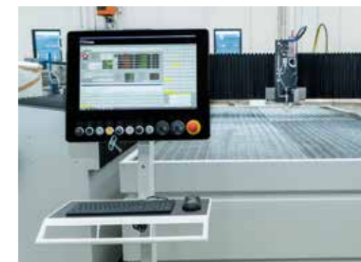
Консоль на подвижной тележке с сенсорным экраном 21,5 дюйма
