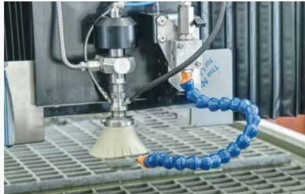
“免维护”疏通系统，用于自动清除多余磨料。槽内的磨料排空系统，受到加工废料篮和金属笼保护。槽总是设计为可以在其后安装整个疏通系统。
