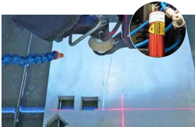
十字激光笔可简化切割台上的板材一个或多个加工起始原点的设置。
