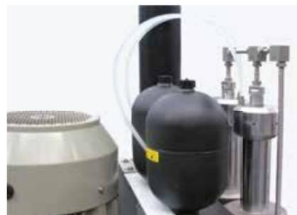
氮气蓄能器，用于管理液缸回流管路
