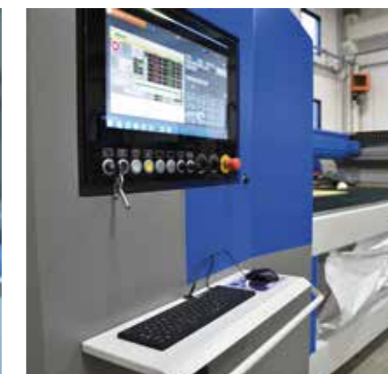
Промышленная панель ПК с диагональю 21,5 дюйма на борту машины с сенсорным дисплеем и интерфейсом CMS Active
