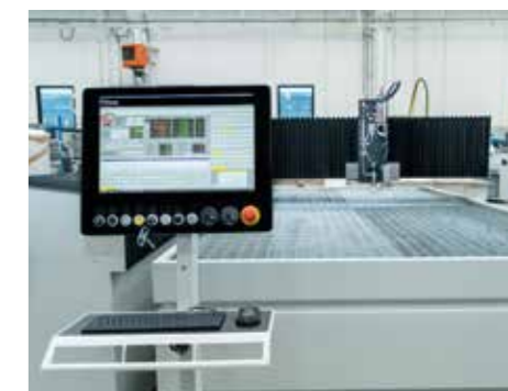
Консоль на передвижной тележке с 21,5-дюймовым сенсорным (опционально)
