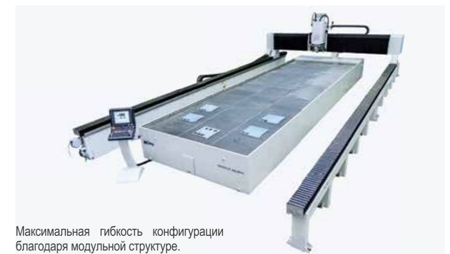
Выносной пульт для управления до 6 осями, что позволяет работать вблизи плоскости резки и устанавливать несколько исходных точек.
