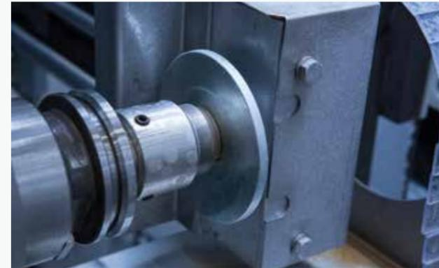
Можно использовать инструменты с трубным патроном 1/2" длиной 75 или 95 мм. Комбинированные фрезы, конические зенкеры и круги для шлифовально-фрезерных работ.
