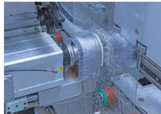
Машина оснащена двумя противоположными прижимами, предназначенными для стабилизации детали во время обработки.
