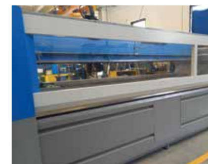
Передняя и задняя дверцы с пневматическим приводом для лучшей защиты зоны резки и сдерживания отражения воды и абразива
