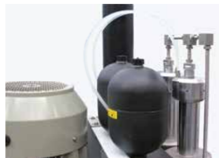
Аккумулятор азота для управления обратным контуром гидроцилиндров
