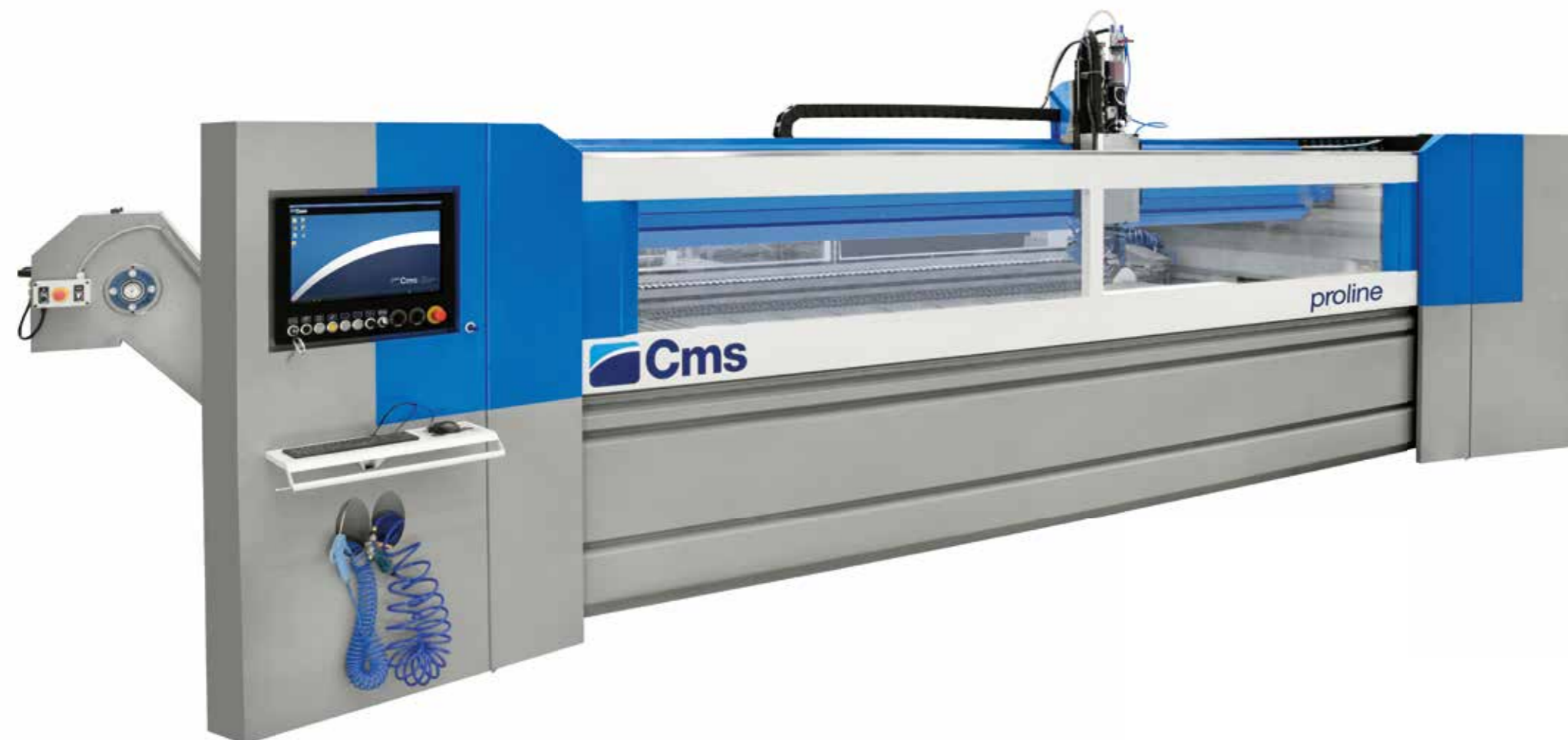
Выносной пульт для управления до 6 осями, что позволяет работать вблизи стола резки и устанавливать несколько исходных точек
