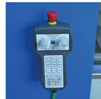
Выносной пульт для управления до 6 осями, что позволяет работать вблизи стола резки и устанавливать несколько исходных точек
