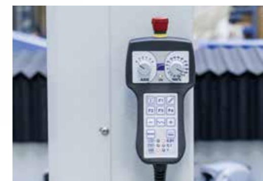
Выносной пульт для управления до 6 осями, позволяющий работать близко к плоскости резки и установить несколько исходных точек (опционально)
