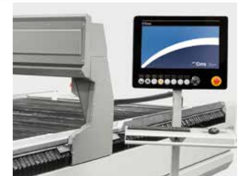
Консоль на передвижной тележке с 21,5-дюймовым сенсорным (опционально)
