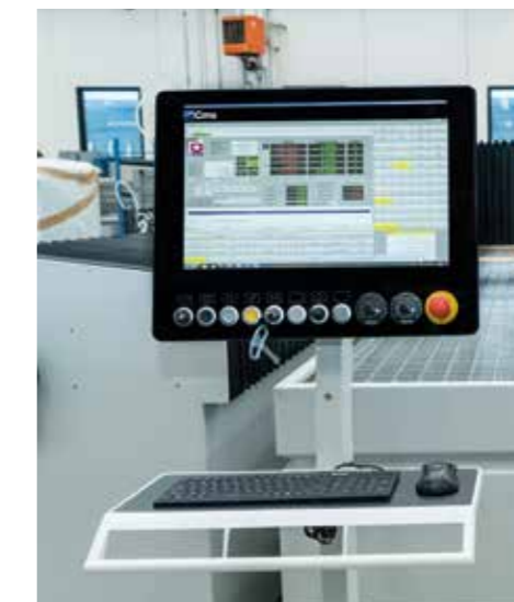
Консоль на передвижной тележке с 21,5-дюймовым сенсорным экраном
