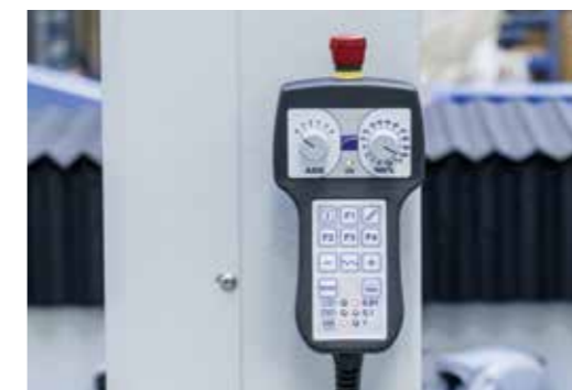
Botoeira remota para controlo de até 6 eixos que permitem operar perto do plano de corte e de configurar multi-fontes (opcional)
