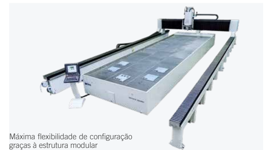
Botoeira remota para controlo de até 6 eixos que permitem operar perto do plano de corte e de configurar multi-fontes
