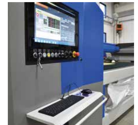
Painel PC Industrial de 21,5" a bordo da máquina com ecrã tátil e interface HMI CMS Active
