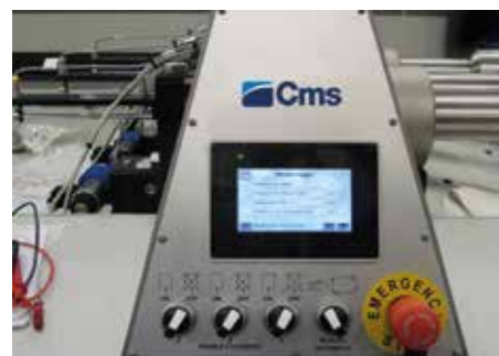
Contrôle électronique de la pression de coupe
