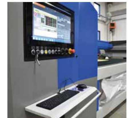
Panneau PC industriel 21,5" sur la machine avec écran tactile et interface HMI CMS Active
