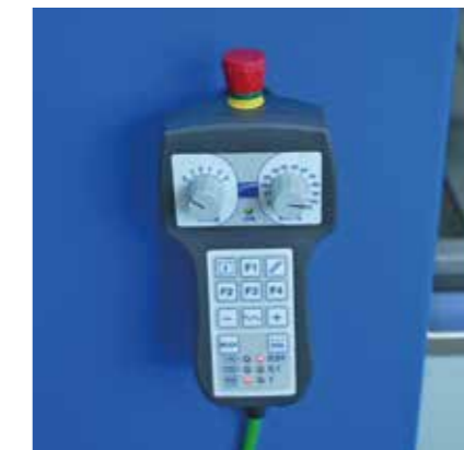
Fernbedienfeld für die Steuerung von bis zu 6 Achsen, für die Arbeit in der Nähe des Schneidtisches und die Einstellung von ehrefachursprungspunkten
