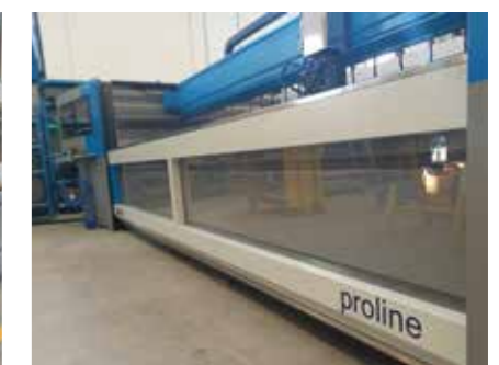
Vordere und hintere Klappe mit pneumatischer Bewegung für den besseren Schutz des Schneidbereichs und die Eindämmung von Wasser- und Schleifmittelspritzern.
