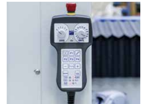
最多可控制6轴的远程按键板,允许靠近切割台操作并设置多个原点(选配)。
