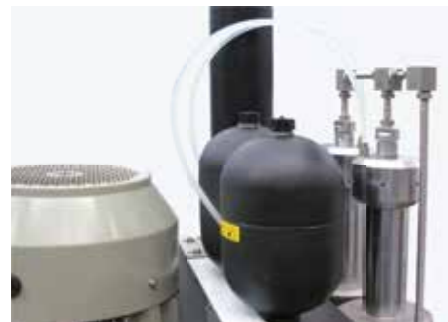
氮气蓄能器，用于管理液缸回流管路
