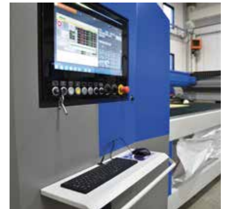
机载21.5英寸工业计算机面板，带触摸显示屏和HMI CMS Active界面。
