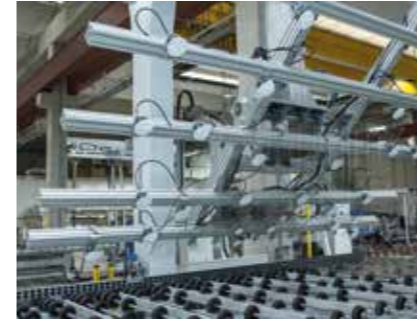
Système de manipulation automatique des plaques de verre
