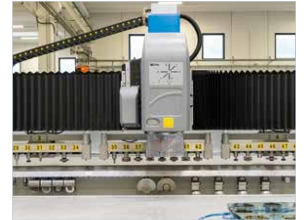
Magasins installés sous la traverse jusqu'à 24 outils.
