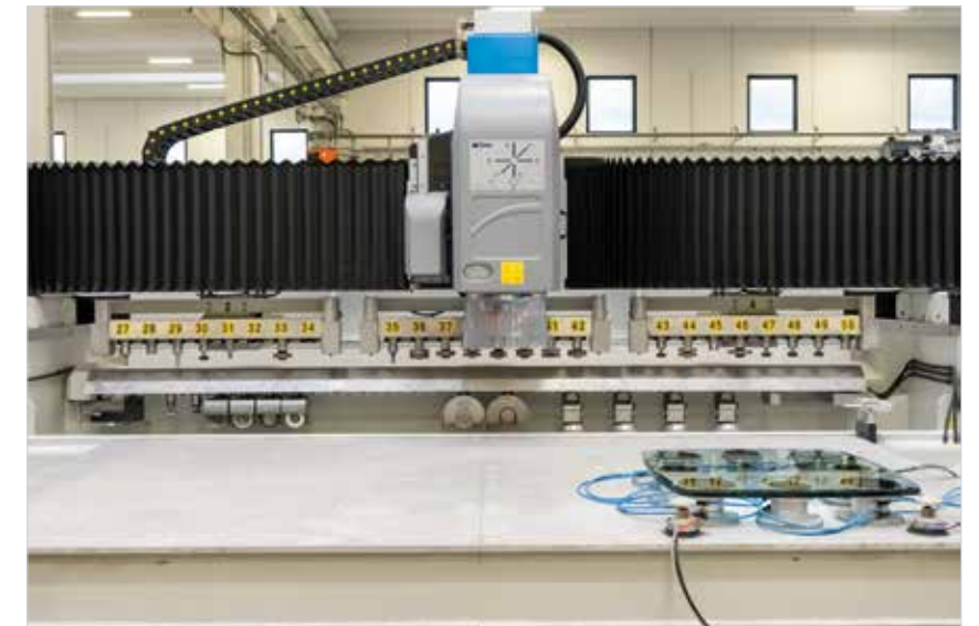
Magasins installés sous la traverse jusqu'à 24 outils.
