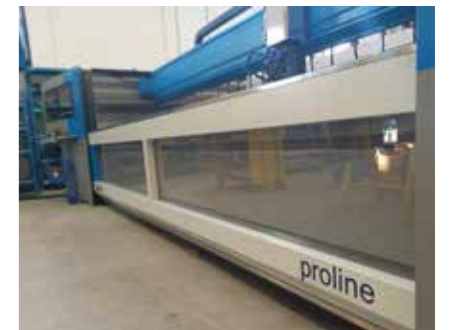
气控移动的前后门板可更好地保护切割区域并遏制水流与磨料反射。
