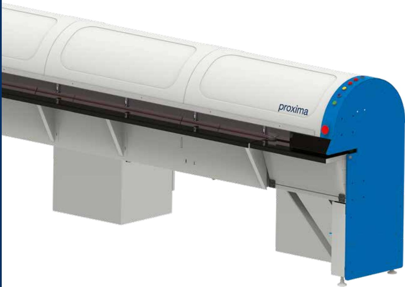
La fileteuse automatique horizontale Cms proxima est la **solution idéale** pour toutes les petites et moyennes verreries qui doivent se lancer dans le filetage avec un **faible investissement**. Cette machine a été conçue pour être combinée aussi bien avec les tables de coupe inclinables pour verre monolithique qu'avec les tables de coupe pour verre laminé.
