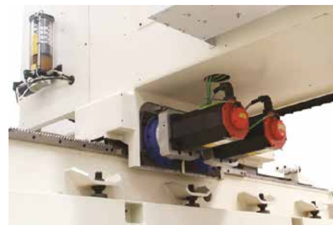
Кинематика с электрическим восстановлением люфта (двойной двигатель) для обеспечения большей жесткости и точности
