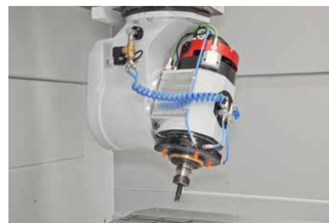
5-осевая режущая головка с технологией прямого привода
