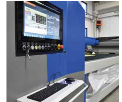
Промышленная панель ПК с диагональю 21,5 дюйма на борту машины с сенсорным дисплеем и интерфейсом CMS Active.
