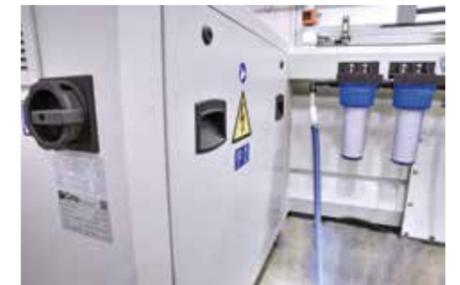
Quadro elétrico integrado na base do tanque para reduzir o espaço no chão.
