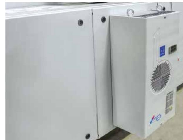
Condicionador de armário elétrico da mesa de corte para temperaturas ambiente compreendidas entre 35 °C e 40 °C.
