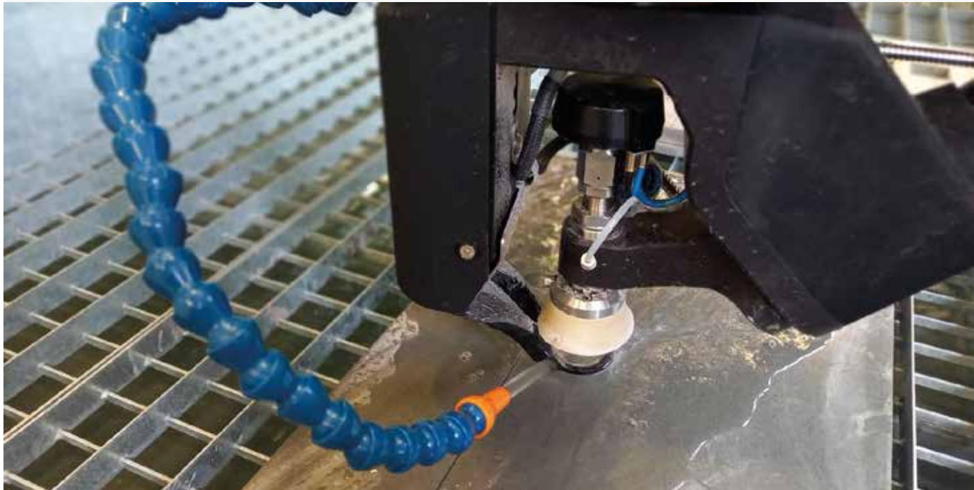
SISTEMA DI LAVAGGIO DEL PEZZO Sistema di lavaggio dell'area di lavoro per ridurre le probabilità di graffiare la superficie del pezzo, permettendo inoltre al tastatore di rilevare correttamente lo spessore del materiale. (opt)
