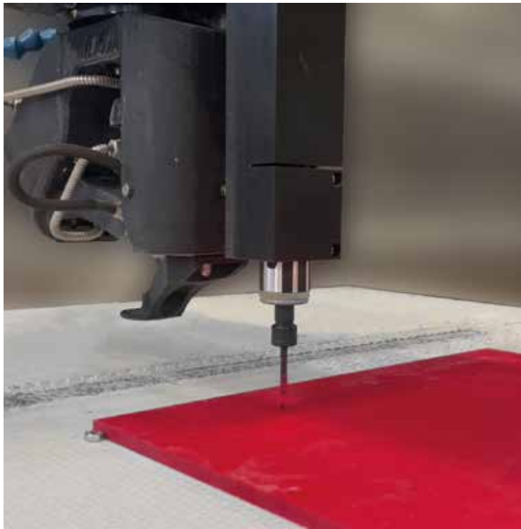
UNITÀ A FORARE Unità pneumatica di foratura controllata da CNC per asse Z. Può essere regolato sull'asse Z (da 0 a 30 mm) per alloggiare diverse punte di foratura. L'unità a forare può essere installata nella versione con uno o due assi Z.
