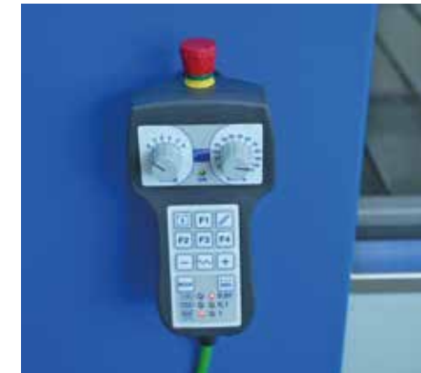
Pulsantiera remotata per controllo fino a 6 assi che consente di operare vicino al piano di taglio e di impostare multiorigini.
