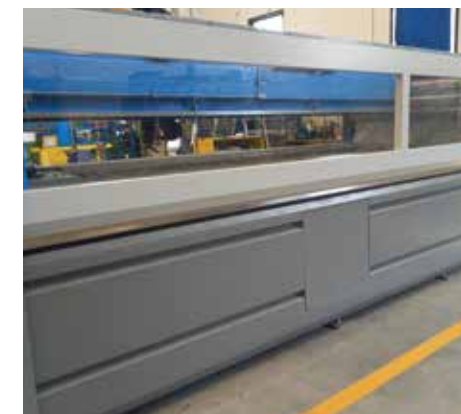
Portella frontale e posteriore con movimento pneumatico per una migliore protezione dall'area di taglio e contenimento dei riverberi di acqua e abrasivo.
