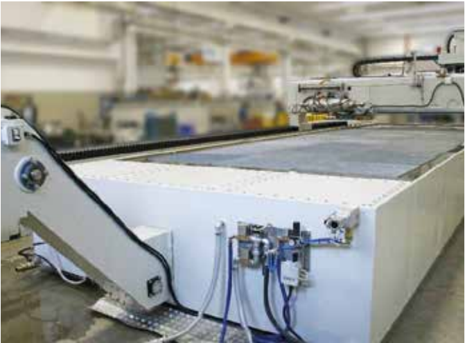
LIVELLO DELL'ACQUA AUTOMATICO Serbatoio integrato nella coda della vasca con pompa per la regolazione automatica (massimo 45 mm) del livello dell'acqua per il taglio sommerso, con il vantaggio di eliminare il rumore generato dal getto d'acqua ultrasonico e mantenere più pulito l'ambiente di lavoro. (opt)
