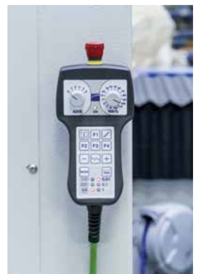
Pulsantiera remotata per controllo fino a 6 assi che consente di operare vicino al piano di taglio e di impostare multiorigini.
