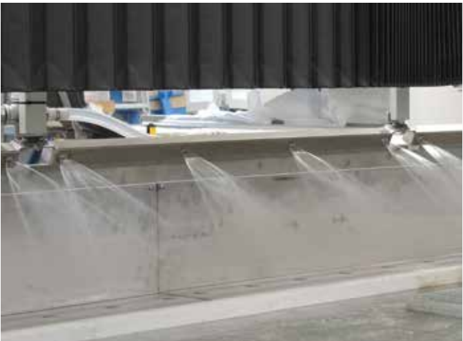
SISTEMA DI LAVAGGIO LASTRA Barra di lavaggio lastra con pompa di ricircolo per la rimozione in automatico dei residui di abrasivo depositati sulla lastra durante il taglio. È stato previsto un ciclo di lavaggio dopo la lavorazione in modo che l'abrasivo non interferisca con le operazioni di movimentazione e bloccaggio lastra.
