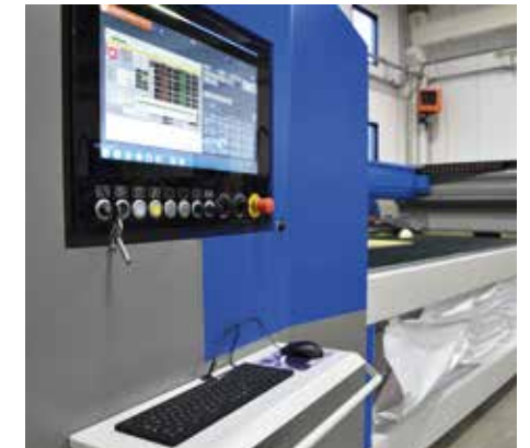
PC Panel industriale da 21,5" a bordo macchina con display touch e interfaccia HMI CMS Active.
