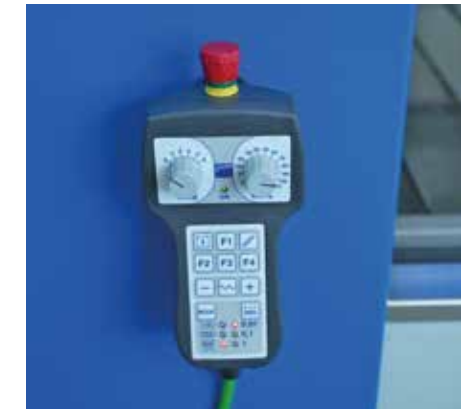
Fernbedienfeld für die Steuerung von bis zu 6 Achsen, für die Arbeit in der Nähe des Schneidtisches und die Einstellung von Mehrfachursprungspunkten.
