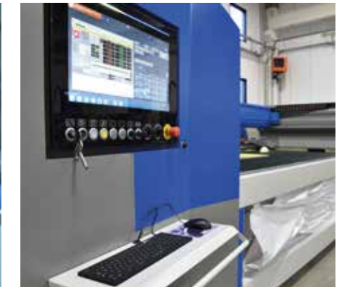
21,5"-Industrie-Panel-PC auf der Maschine mit Touch-Display und HMI-Schnittstelle CMS Active.
