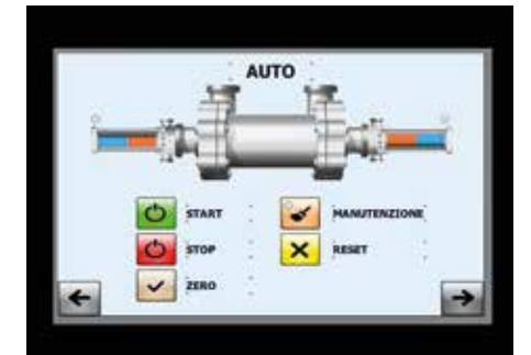
TOUCH-STEUERUNG 17" für Ferndiagnose, Leistungsprüfung, Zyklanzahl und elektronische Drucksteuerung
