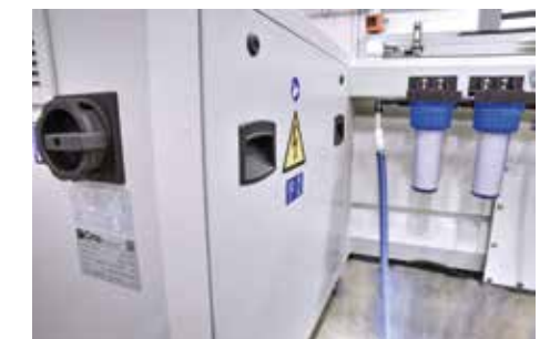
Um den Platzbedarf zu reduzieren, wurde die Schalttafel im Untergestell des Behälters integriert.
