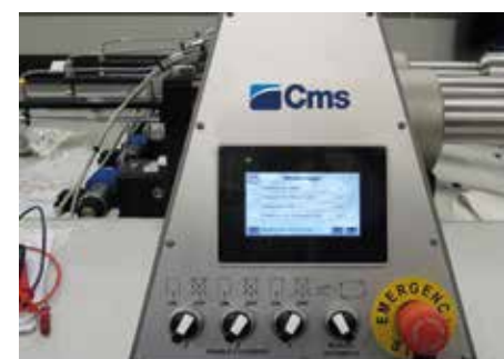
Elektronische Steuerung des Schneiddrucks
