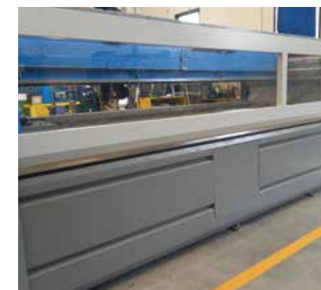
Vordere und hintere Klappe mit pneumatischer Bewegung für den besseren Schutz des Schneidebereichs und die Eindämmung von Wasser- und Schleifmittelspritzern.
