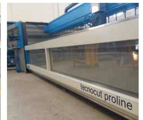
Vordere und hintere Klappe mit pneumatischer Bewegung für den besseren Schutz des Schneidebereichs und die Eindämmung von Wasser- und Schleifmittelspritzern.
