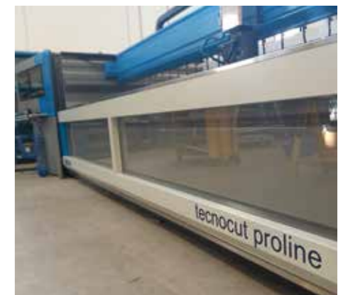
气控移动的前后门板可更好地保护切割区域并遏制水流与磨料反射。
