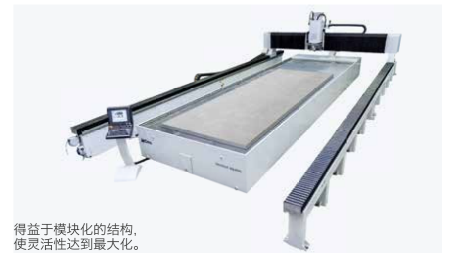
最多可控制6轴的远程按键板，允许靠近切割台操作并设置多个原点。
