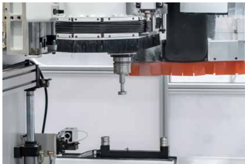
ПЕРЕПОДГОТОВКА Возможна контактная или лазерная переподготовка для калибровки осей и измерения диаметров и длин инструмента.
