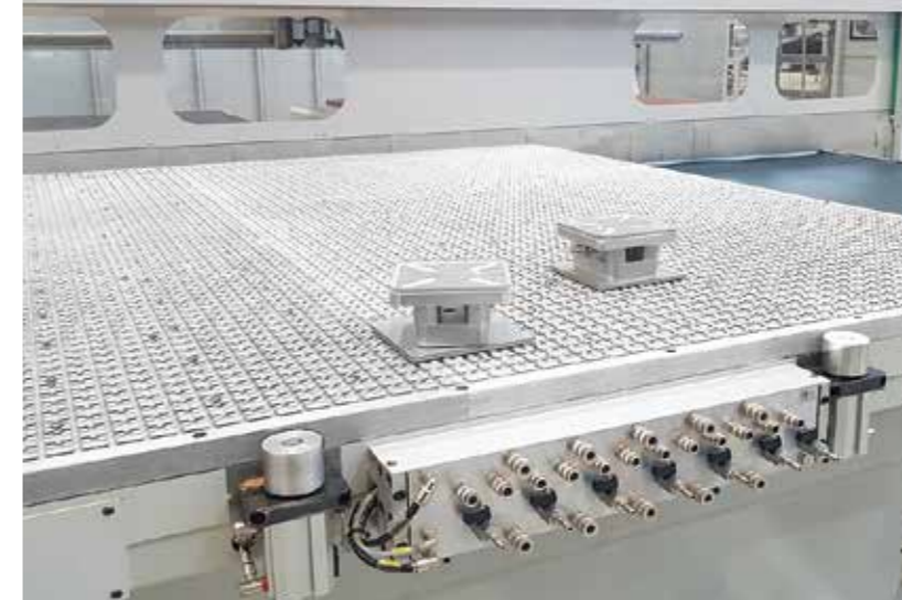
БЛОКИ РАСПРЕДЕЛЕНИЯ ВОЗДУХА/ВАКУУМА Для использования зажимов, присосок или под специальными деталями.
