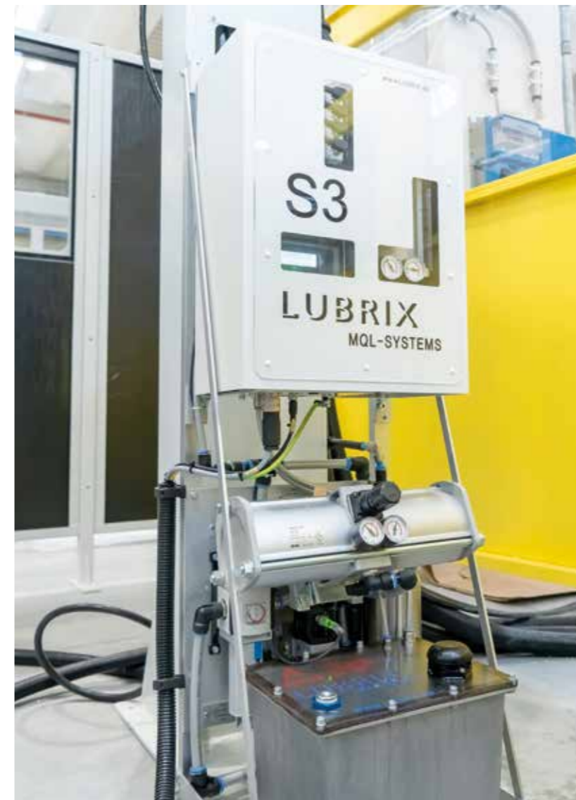
СИСТЕМЫ MQL Максимальная эффективность при минимальном расходе смазки. Системы MQL в сочетании с электрошпинделями, пропускающие воздух/масло внутрь инструмента, гарантируют идеальную смазку даже в критических ситуациях.
